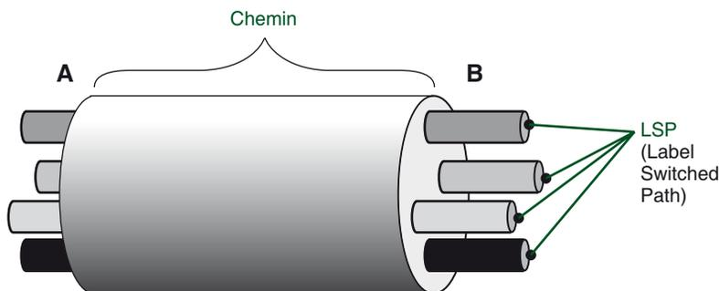
La figure R.7 représente un cas simple. Dans la réalité, MPLS fait appel à une solution de signalisation formant des FEC (Forwarding Equivalence Class). Toutes les communications qui ont une même destination se rassemblent sur un même circuit virtuel. Au
