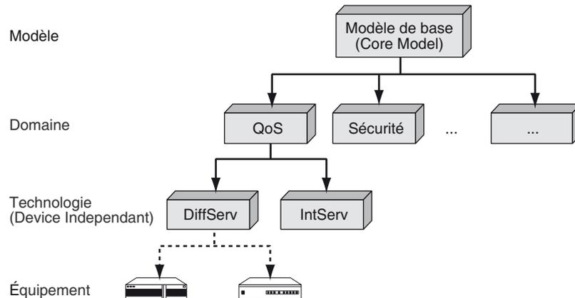
Si l'on ne se préoccupe que de la branche QoS, ou qualité de service, la structure des modèles successifs permet de passer de la définition générale d'une politique de qualité de service à la configuration d'un routeur.
