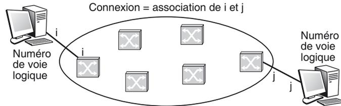
Le niveau paquet de X.25 permet un maximum de 16 groupes de 256 voies logiques entre un ETDD et un ETCD. L'en-tête du paquet contient un champ de 4 bits qui identifie le groupe et un champ de 8 bits pour le numéro de la voie logique. 4 095 voies logiques — la voie 0 joue un rôle particulier — sont donc utilisables sur une entrée. L'ETDD et l'ETCD partagent le même numéro de voie logique lors de la formation de la connexion.
