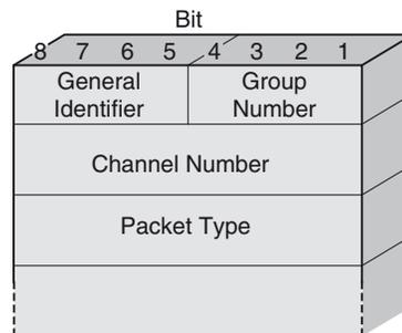
La zone identificateur de type de paquet (Packet Type) permet de déterminer la fonction du paquet. Elle ressemble à la zone de supervision de HDLC pour le contrôle de la connexion réseau. Le tableau F.1 répertorie les différents types de paquets rencontrés dans le protocole X.25.
