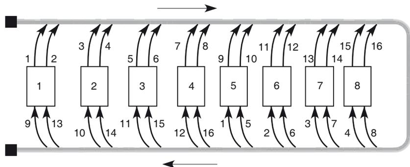
L'avantage de cette technique est d'avoir plusieurs chemins utiles en cas de panne. Ces chemins ont une longueur variable. S'il y a trop d'embouteillage, on peut toujours prendre un autre chemin, certes plus long, pour atteindre le destinataire. Le support est une fibre qui prend en charge 16 canaux multiplexés en longueur d'onde. Sur la figure, pour aller
