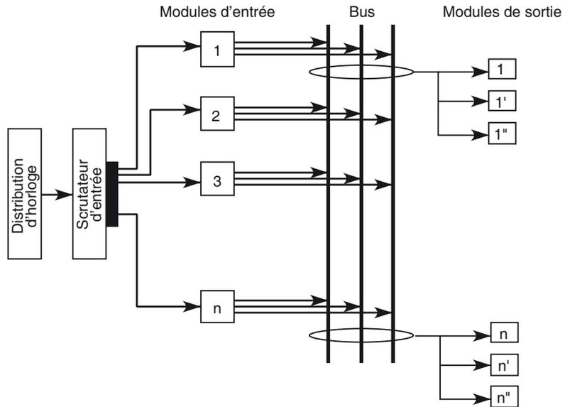
Le scrutateur d'entrée a pour fonction de prendre l'information contenue dans la porte d'entrée et de la déposer sur le bus, en synchronisation avec un signal d'horloge. Lors du top d'horloge suivant, une nouvelle entrée est scrutée, et sa cellule est insérée sur le bus.
