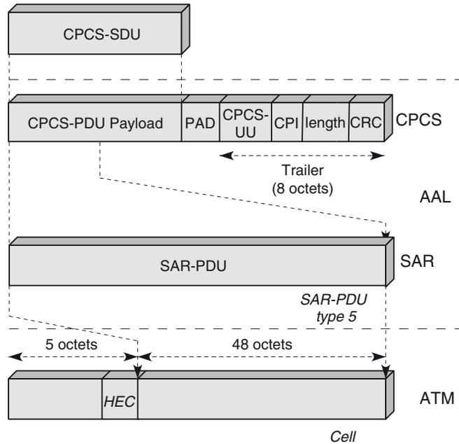
On retrouve dans le champ de supervision de fin de trame la zone Length, qui indique la longueur de la CPCS-SDU, et la zone CPI. La zone CRC, sur 4 octets, permet de détecter les erreurs sur la CPCS-PDU.
