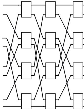
En prenant, par exemple, la troisième entrée à partir du haut et en suivant toujours tout droit dans les commutateurs élémentaires, on se retrouve sur la troisième ligne de sortie. À la  $i$ ème ligne d'entrée correspond la  $i$ ème ligne de sortie.
