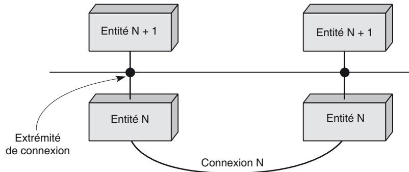
À une extrémité de connexion N correspond une adresse N. Pour qu'une connexion s'établisse, il faut que les deux entités qui veulent communiquer disposent des mêmes éléments de protocole et d'une connexion N - 1. Une fois les données utilisateur N transférées, il faut libérer la connexion. Il existe pour cela deux possibilités :
