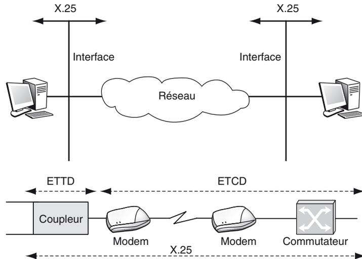
La définition de X.25 a été étendue pour prendre en compte des transmissions sur les interfaces soit d'entrée du réseau, entre la machine de l'utilisateur (ETTD) et l'équipement d'accès de l'opérateur (ETCD), soit de la machine de l'utilisateur à la machine distante (ETTD à ETTD).
