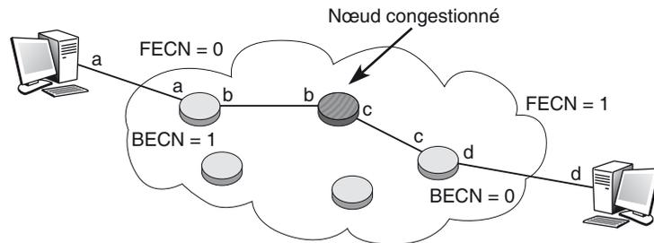
Les bits FECN et BECN sont toujours mis à 0, respectivement par l'émetteur et le récepteur, dans la structure de la trame émise sur la liaison virtuelle. Lorsque ces bits passent par un nœud congestionné, ils sont automatiquement mis à 1. Le récepteur et l'émetteur sont donc informés de l'état de congestion d'un nœud par la réception de ces deux bits à 1.
