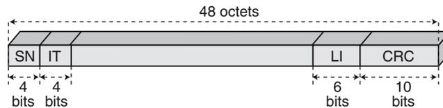
Dans la structure de la SAR-PDU, on trouve quatre zones de supervision :
