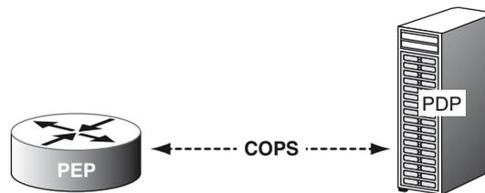
Le PEP peut être un routeur supportant RSVP ou un routeur supportant un service de gestion de la qualité de service, comme DiffServ, ou encore un nœud appliquant un contrôle quelconque. Le PEP fournit des informations au PDP concernant les décisions prises et les politiques installées. COPS transporte les messages d'erreur faisant suite à la détection d'un problème lors de l'installation d'une politique ou à un échec détecté lors de l'installation de la configuration sur le PEP.
