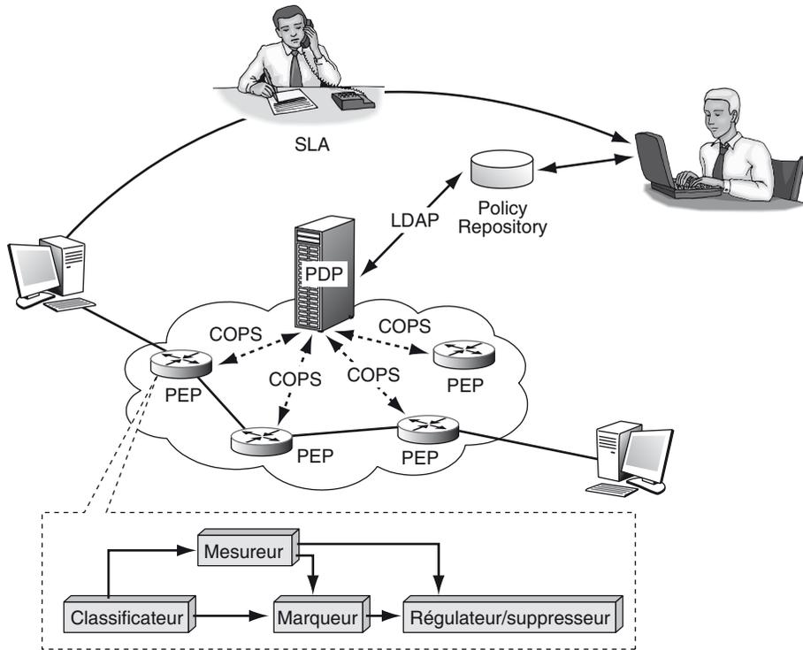
La figure S.13 présente les requêtes échangées entre le PDP et le PEP pour une communication de provisioning (PR) avec un protocole COPS qui prend alors le nom de COPS-PR. Cette communication s'effectue par l'émission d'une requête REQ du PEP vers le PDP. Le PDP répond par une commande DEC précisant la configuration à mettre en œuvre dans le PEP.
