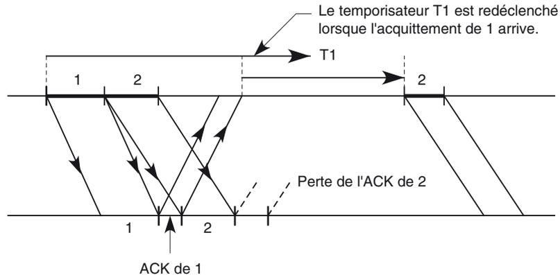
La première solution permet de réémettre plus rapidement des TPDU erronées ou perdues mais exige davantage du logiciel, qui doit gérer autant de temporisateurs que de TPDU émises.
