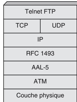
CIOA se place au niveau 3 de l'architecture OSI et utilise une résolution d'adresse IP directement en ATM. La résolution d'adresse de l'émulation LAN opère pour sa part au niveau MAC. Ce sont bien sûr deux solutions incompatibles. CIOA est beaucoup plus simple que l'émulation LAN, mais elle ne permet pas de gérer la diffusion.
