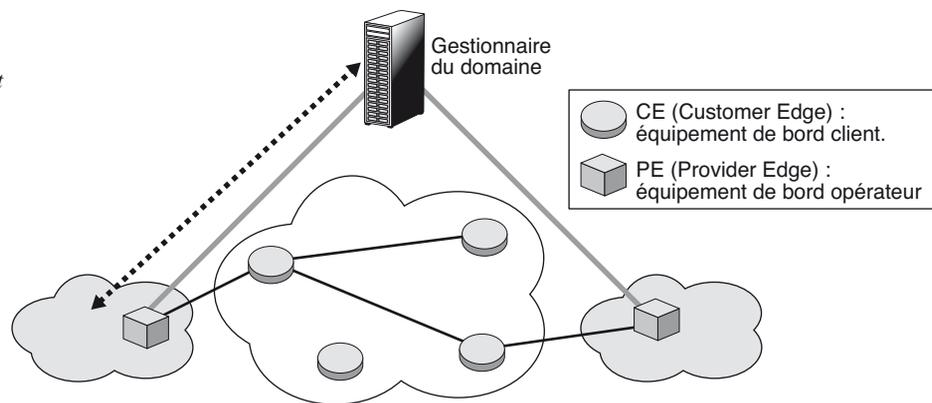
Dans le cas d'une négociation intradomaine, par exemple CE-to-CE, les CE sont gérés par un même opérateur. La négociation du SLS a lieu entre un client situé au niveau d'un réseau d'entreprise et l'opérateur. Si nous prenons l'exemple d'un client situé dans le réseau d'entreprise de gauche de la figure R.3, le trait en pointillé indique la négociation du SLS pour un VPN à mettre en place entre le CE du réseau de gauche et le CE du réseau de droite.
