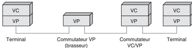
Dans un brasseur de conduits, on commute simultanément toutes les voies virtuelles à l'intérieur du conduit. On a donc intérêt à regrouper les voies virtuelles qui vont vers la même destination de façon à les intégrer dans un même conduit. Cela simplifie grandement les problèmes de commutation à l'intérieur du réseau. La figure K.10 illustre, de façon assez symbolique, un même conduit partagé par un ensemble de voies. Le long du conduit, des brasseurs VP peuvent se succéder.
