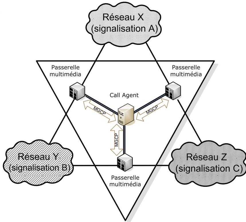
X, Y ou Z représentent des réseaux quelconques (RNIS, ATM, IP, RTC, etc.). Sur chacun de ces réseaux, le protocole de signalisation intra-réseau de son choix peut être utilisé, par exemple SIP ou H.323 dans un réseau IP, ou SS7 dans un réseau RTC. MGCP ne peut s'appliquer au sein de ces réseaux, mais seulement à leur périphérie afin d'assurer la gestion et le traitement des communications inter-réseau.
