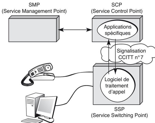
Une première amélioration de cette architecture est illustrée à la figure W.8. Dans cette architecture, appelée IN1+, apparaissent les fonctions élémentaires, ou EF (Elementary Function), qui forment les éléments de base dans les points d'accès au service. Ces éléments doivent être choisis ou adaptés à la prise en compte d'un nouveau service.
