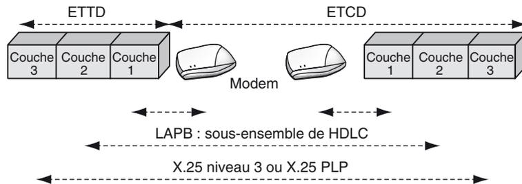
La recommandation X.25 du CCITT définit les types de paquets et leur format mais ne spécifie pas comment certaines informations de contrôle doivent être interprétées. En particulier, la fenêtre de contrôle de flux peut être interprétée au niveau local entre l'ETTD et l'ETCD ou au niveau global entre l'ETTD émetteur et l'ETTD récepteur. Ces imprécisions donnent naissance à des réseaux très différents les uns des autres.
