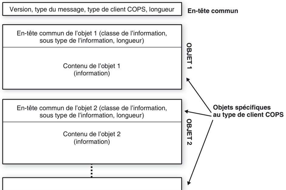
COPS comporte les 16 classes d'objets, ou plutôt classes d'information de contenu d'objets, récapitulées au tableau T.4. La structure des objets est soit précisée dans la RFC, soit étendue et définie dans les extensions du protocole.
