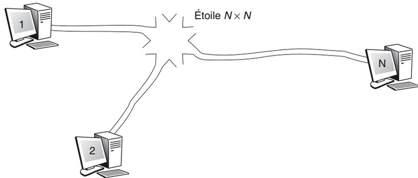
Le commutateur Lambdanet se caractérise par une étape, une liaison dédiée, une commutation spatiale, pas de contrôle *a priori*, des mémoires en sortie et pas de blocage.
