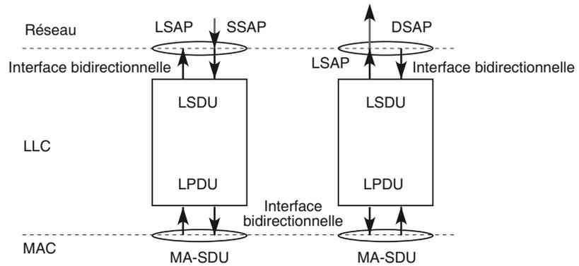
Les primitives de contrôle des interactions entre la couche réseau et la couche LLC sont représentées à la figure E.10.
