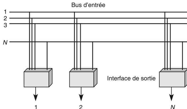
Si plusieurs trames se présentent sur le même commutateur élémentaire, l'une d'elles est mise en attente de telle sorte qu'une seule trame sorte vers  $n$ . Le commutateur interne à l'interface de sortie est illustré à la figure D.3.
