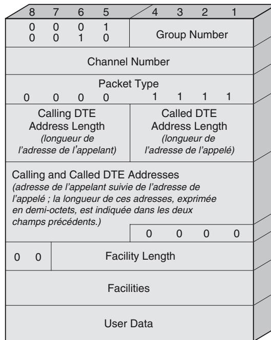
Le paquet contient un premier champ indiquant les options de contrôle du circuit virtuel et un second, de 64 octets au maximum, destiné à l'utilisateur. Ce dernier peut utiliser ce champ pour préciser, entre autres, des adresses complémentaires, si l'adresse du récepteur est un réseau local ou un autocommutateur privé, et des mots de passe.
