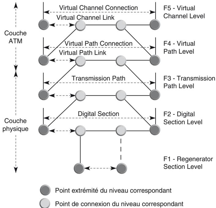
Le flot F5 concerne le niveau de la voie virtuelle. Les cellules OAM du flot F5 sont identifiées par le champ PT (Payload Type), qui se trouve dans la zone de supervision. Ce champ indique une valeur PTI (Payload Type Identifier). La cellule OAM, pour chaque direction du flot F5, doit suivre une même route physique, de telle sorte que chaque nœud soit au courant de toutes les informations transportées dans un sens ou dans l'autre.
