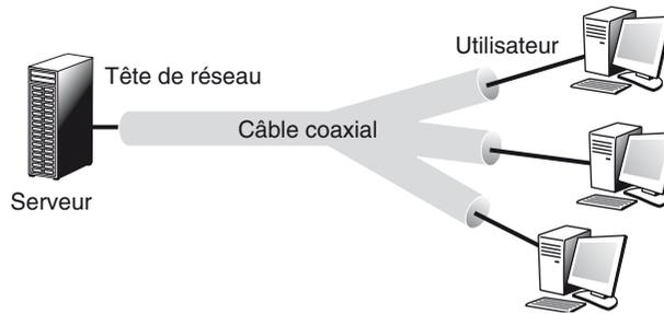
Le câblage part d'une tête de réseau pour atteindre l'utilisateur après une diffusion sur l'ensemble des branches. Dans le cadre de la diffusion de la télévision, les différents programmes sont poussés vers les utilisateurs. Chaque abonné reçoit l'ensemble des chaînes et en sélectionne une à visualiser. Cette technique est à l'opposé de l'ADSL, où seule la chaîne sélectionnée par l'utilisateur est acheminée.
