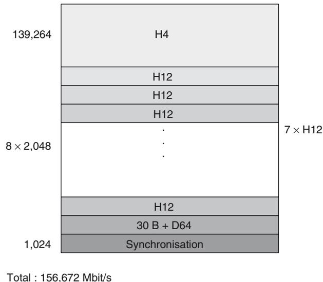
La difficulté principale de ce multicircuit réside dans la gestion du circuit multipoint. Il faut développer une interface unique avec l'utilisateur susceptible de multiplexer les données provenant des différentes sources et de les démultiplexer dans le sens opposé.
