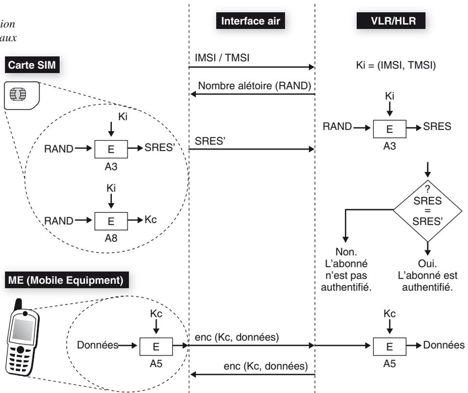
L'algorithme A5 est implémenté dans chaque terminal et dans le réseau. Les implémentations des algorithmes A3 et A8, aussi appelés COMP128, existent sur Internet, mais aucun standard n'a encore été publié.
