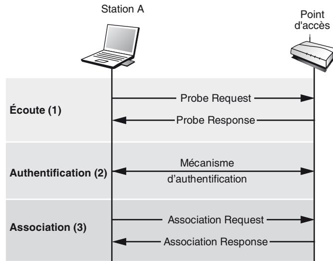
Une fois la station associée avec le point d'accès, elle se règle sur le canal radio de ce dernier et peut commencer à transmettre et recevoir des données.
